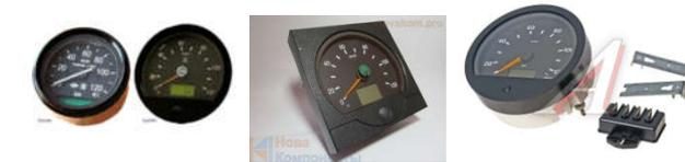
**4.2. Спидометры электронные** типа 56.3802 и аналогичные, с автомобилей производства СССР и СНГ:
