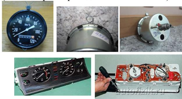
**3. Спидометры электрические** (спидометры с приводом от датчика МЭ 307 и т.п.):
